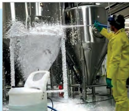
Рис. 4. Санитарная обработка с помощью пеногенератора
